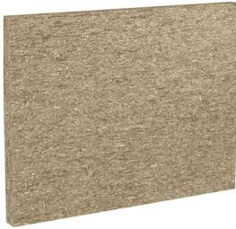
Hanffaser Putzträgerplatte zur dübelfreien Verarbeitung auf hochporosierten Ziegeln wirkt spannungsreduzierend für die Deckbeschichtung und vermindert auftretende Wärmebrücken im Deckenbereich.
